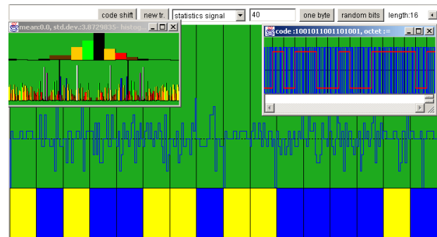
Fig.4: Transmission CDMA, allure et spectre du signal multiplexé (coin haut-gauche), du signal originel et codé d'un utilisateur (coin haut-droit).
